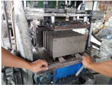
รูปภาพที่ 9 การบีบคอนกรีตบล็อก
