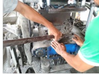
รูปภาพที่ 8 การเทส่วนผสมลงในเครื่องบีบคอนกรีต บล็อก
